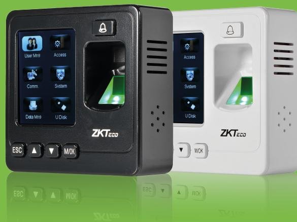
El SF100 es una terminal con lector de huella digital. Se puede conectar con el software ZKAccess3.5 para control de acceso y gestión de tiempo y asistencia.
