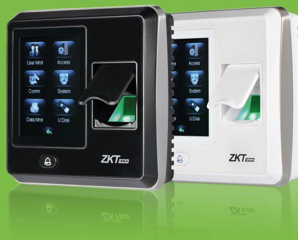
El SF300 es una terminal IP de huella digital, que opera de modo independiente. Se puede conectar con el software ZKAccess3.5 para control de acceso y gestión de tiempo y asistencia.
